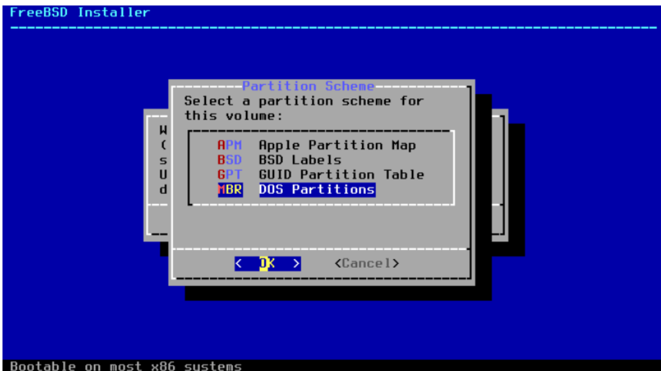
Figure 14. Sélection du système de partitionnement
